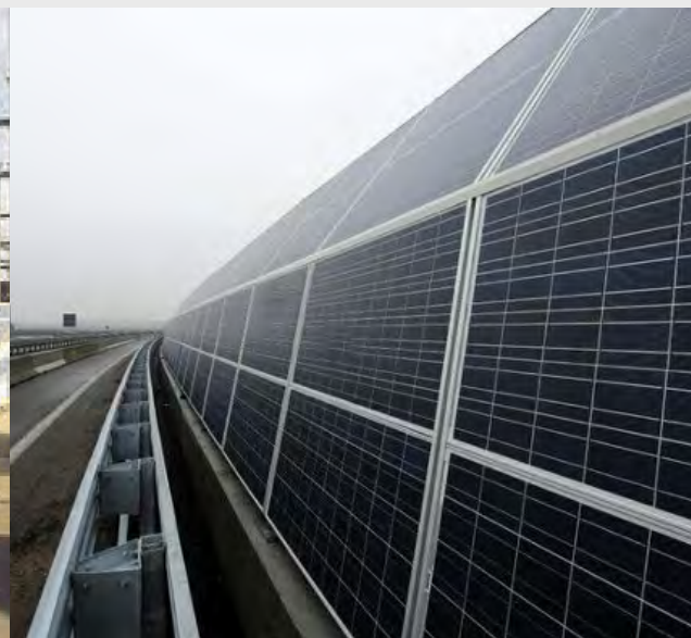
Moduli fotovoltaici utilizzati come barriere antirumore lungo arterie stradali a scorrimento veloce e lungo la ferrovia. Ferrovia di Wallisellen in Svizzera.
