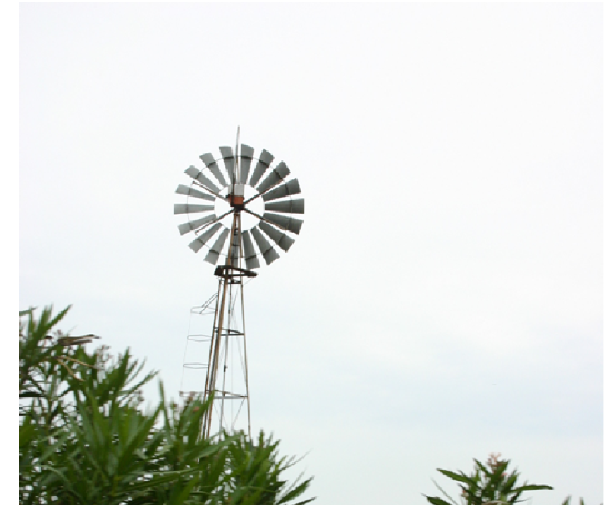
Turbina eolica multipala utilizzata come pompa idraulica a servizio dell'attività agricola.
